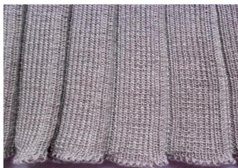
1-сурет. Алдыңғы және артқы инешектерді кезектесіп өшіру есебінен, ластик 1+1 өрімімен тоқылған қатпардың сыртқы түрі
